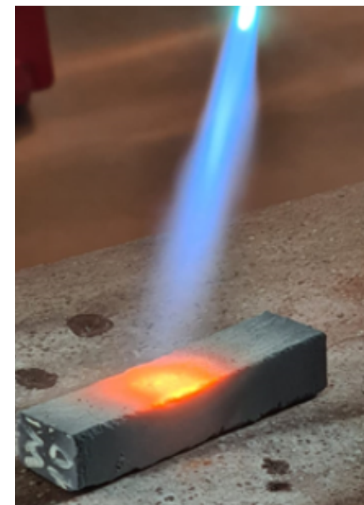
Graphii coat 30 GP in fase di test sotto fiamma ossidrica
